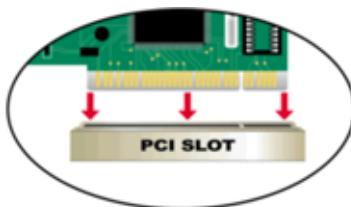
**Замечание:** Во избежание эффекта разряда статического напряжения, пожалуйста, коснитесь неизолированного винта на обратной стороне блока питания компьютера прежде, чем устанавливать DGE-528T.
